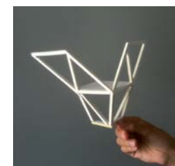
Ci contre: façade nord-ouest du bâtiment principal avec les treillis en acier dans les angles. Ci-dessus: modèle des éléments de renforcement posés dans les angles du bâtiment.
