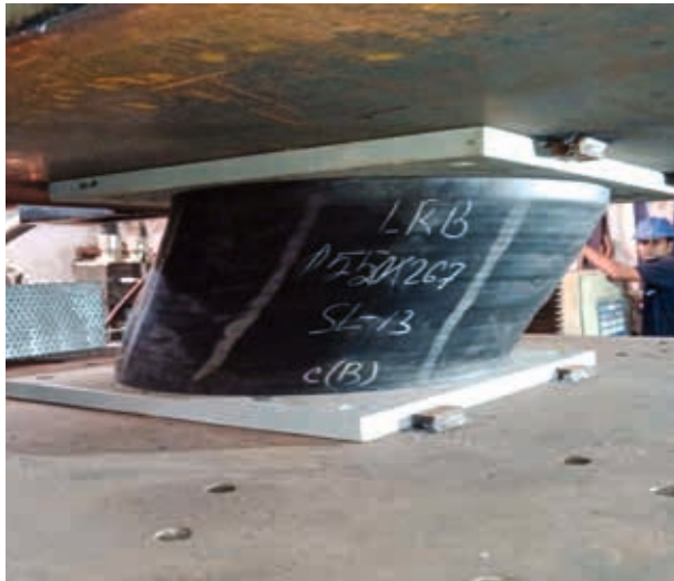
Ein verformbares Elastomerlager mit Bleikern im Prüfstand (oben) und eingebaut unter der Abfahrtsrampe der Brücke zur A9 (unten).
