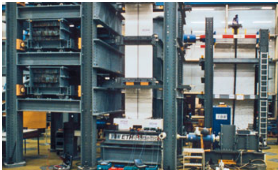
02 Erdbebensimulator am Institut für Baustatik und Konstruktion IBK der ETH Zürich (Fotos: Hugo Bachmann / IBK, ETH Zürich)
