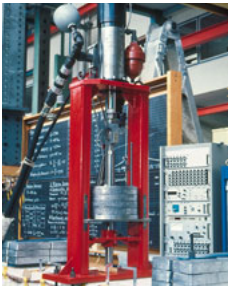
01 Servohydraulischer Schwingungserreger auf einem Stahlbetonbalken
